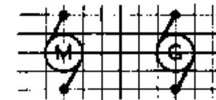
D.C.-D.C. MOTOR GENERATOR
