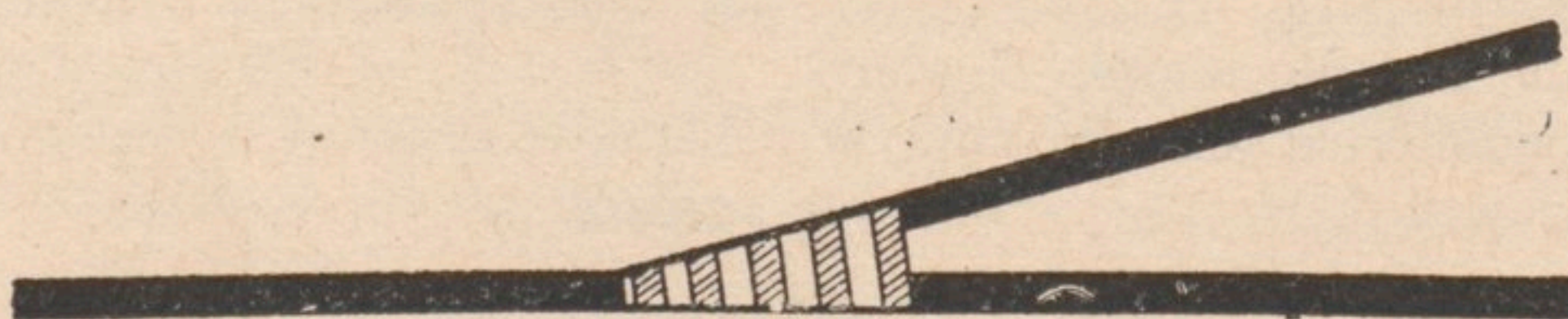
Fig. 8. — Fenêtre d'une aiguille simple derrière laquelle apparaît le voyant fixe, rayé rouge et blanc.
