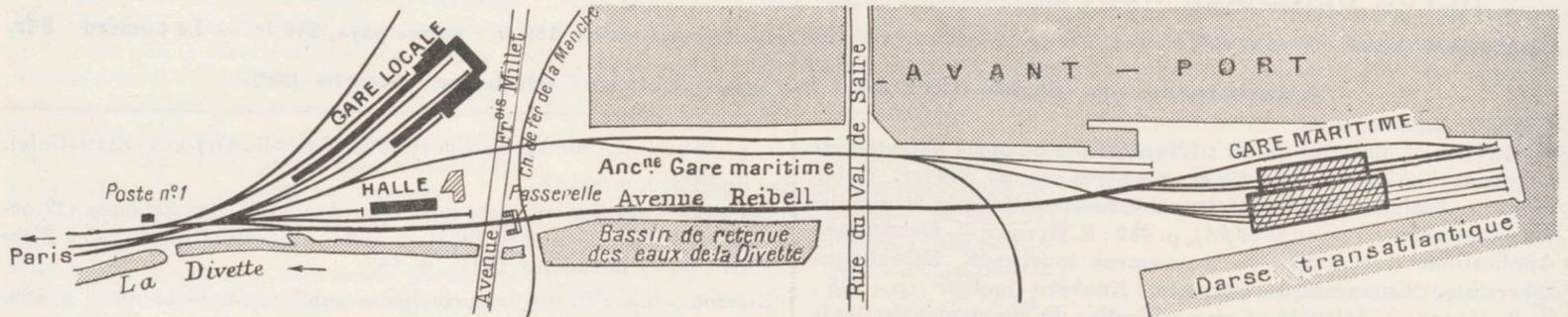
FIG. 2. — Plan schématique montrant le tracé du nouveau raccordement entre la gare locale et la gare maritime de Cherbourg.
