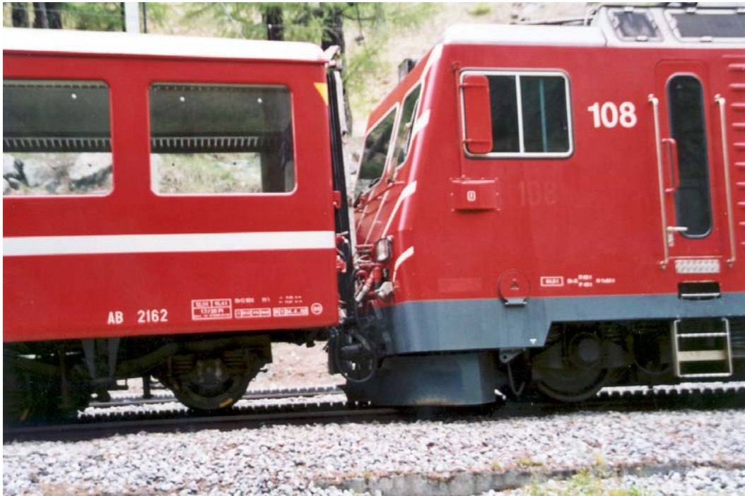
Entgleister Wagen unmittelbar hinter der Lok des Glacier-Express
