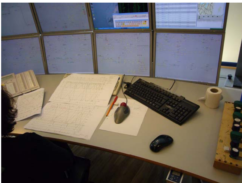
Fig 7. Bild från fjärrtågklararens arbetsplats. I mitten syns de grafiska uppläggen med tangentbordet till EBICOS-systemet under den övre grafen. EBICOS-systemet kan även manövreras med hjälp av en mus.
