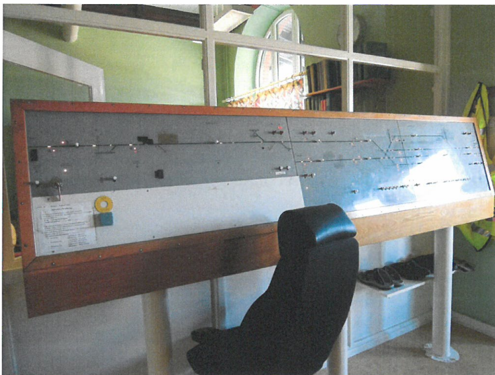
Figur 5. Manöverplatsen för Fagersta (reläställverk typ "Skruv och Björnlunda").
