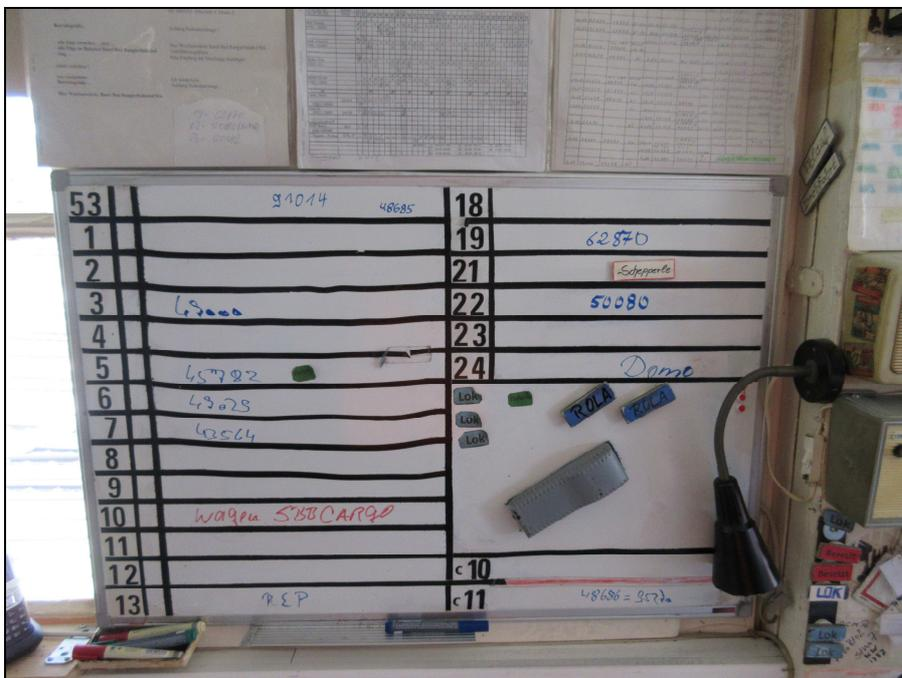
Abb. 10: Gleisbesetzungstafel im Stw 7 (Aufnahme nicht am Ereignistag)
