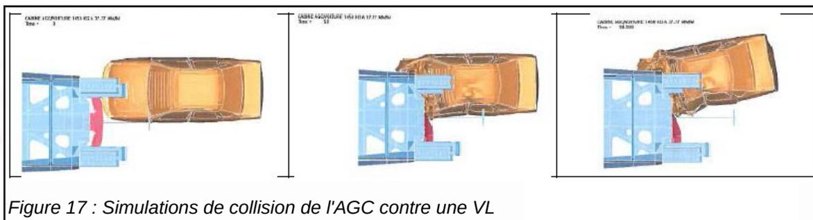
Figure 17 : Simulations de collision de l'AGC contre une VL
