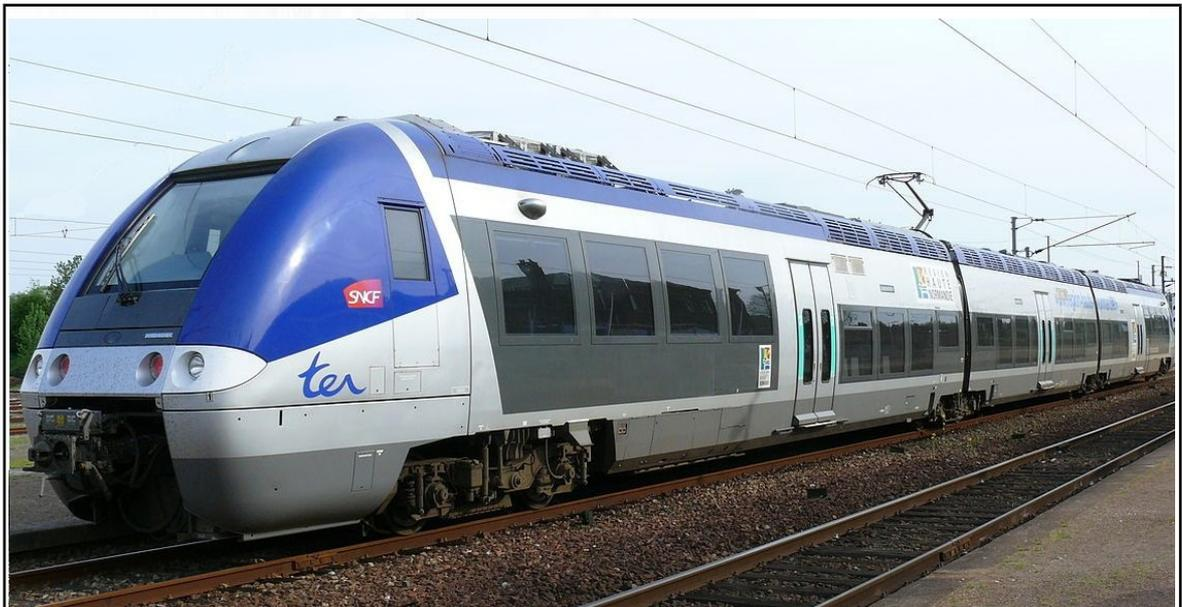
Figure 4 : Vue d'ensemble d'une rame Z 27500 tri-caisse
