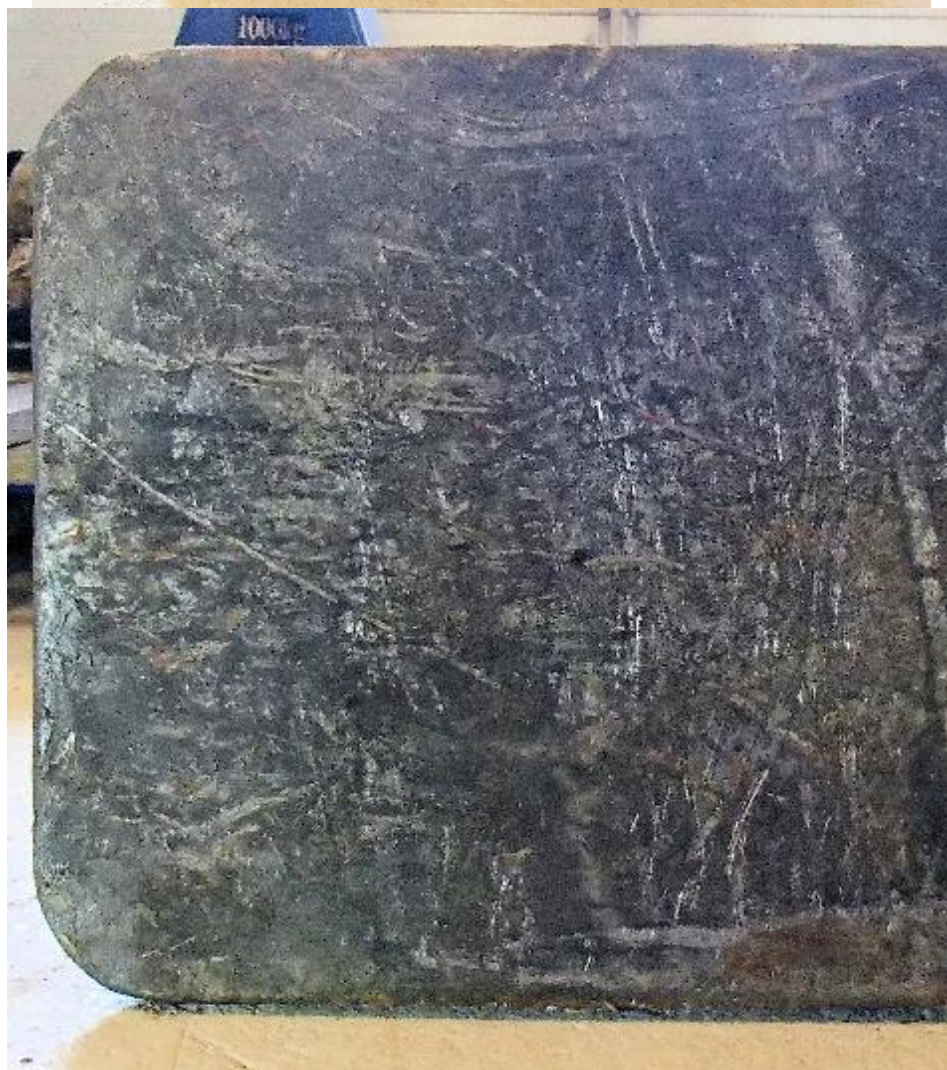
Figur 14 Indikation efter ydre påvirkning af den affaldne puffer (ved rød pil) samt indikationer efter vertikalt slid i nederste foto.
