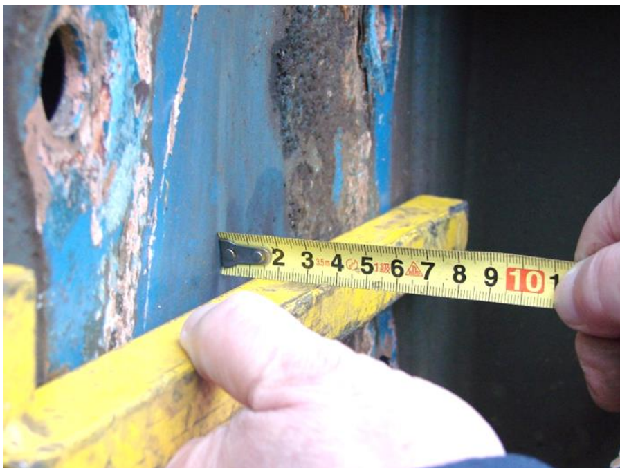
Figur 7 Indtrykning af godsvognen målt til ca. 12 mm.
