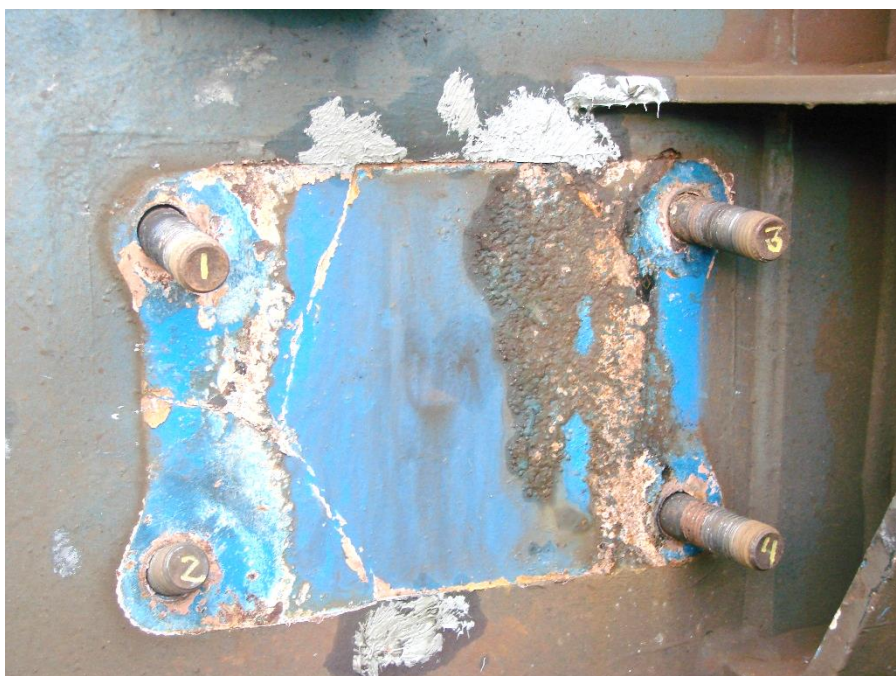
Figur 6 Mærker på godsvognen efter afmontering af pufferens bagplade.
