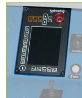
Illustration : GSM-R dans la cabine de conduite d'une AM08.
