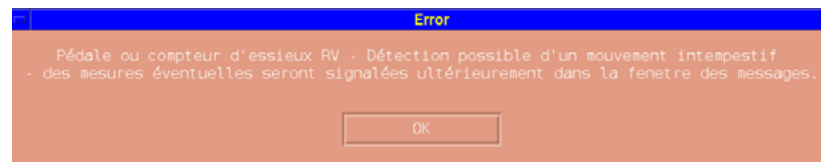
Illustration d'un message d'erreur DOBMI apparaissant sur l'écran EBP.
